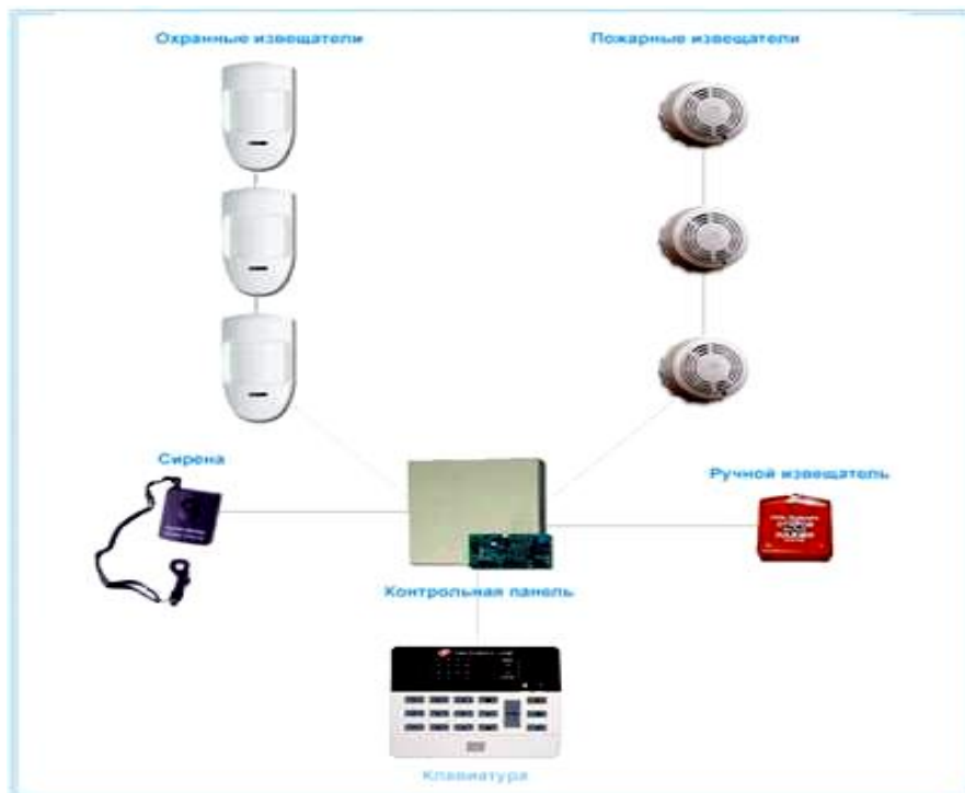
Рис. 3.1. Структурная схема ОПС
